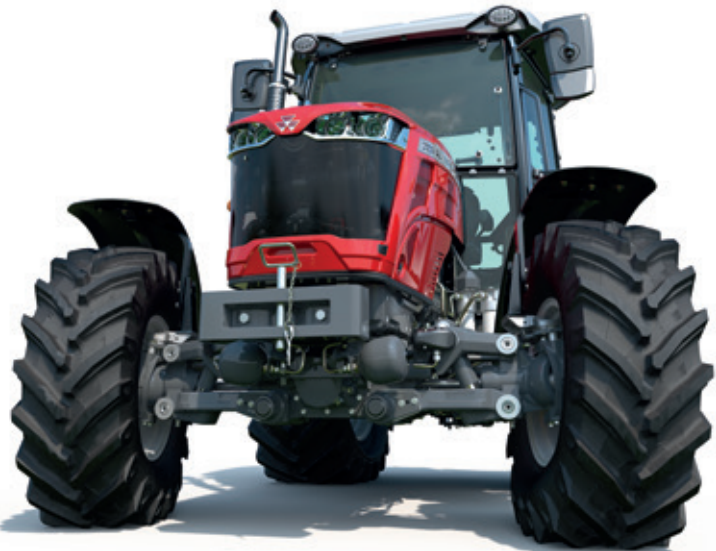
Essieu avant suspendu de la série MF 3700 AL
